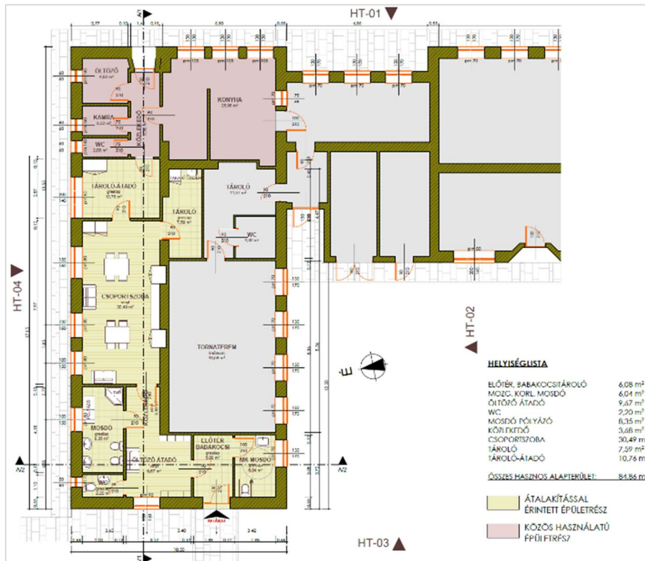
Az átalakítással érintett épületrész és a Közös használatú épületrész lehatárolása, forrás: É.T. 1.1. tervezett alaprajz, 7.sz. melléklet, műszaki dokumentáció
